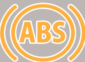
ABS 警告灯 (アンチロック・ブレーキ・システム警告灯)
