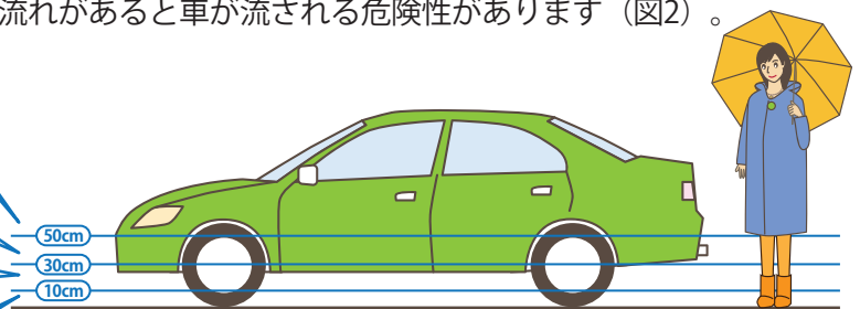
図2: 浸水深別の車の危険性について
